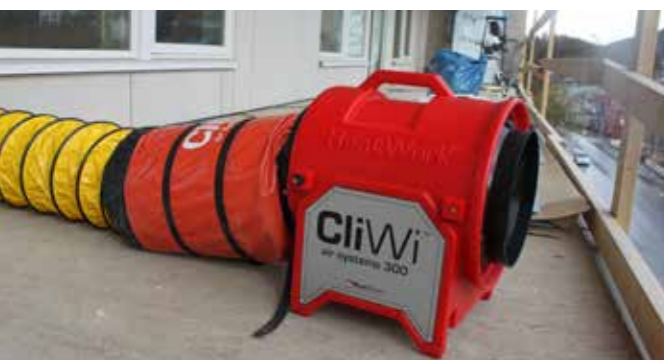
Uppvärmning av bygge.
